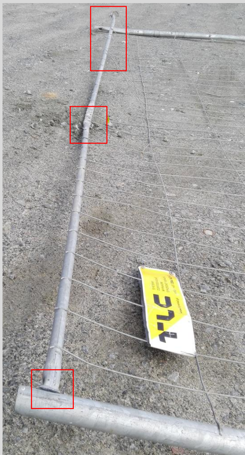
Uszkodzenie niedozwolone – element do KASACJI
