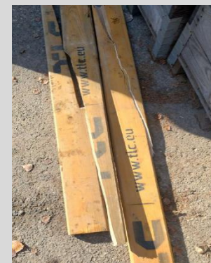
12. Pęknięty element EPS
