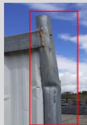
15. Wgniecenie słupka pionowego
