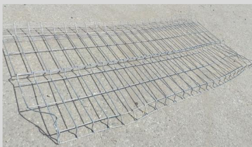
11. Zgniecenie panelu EPS
