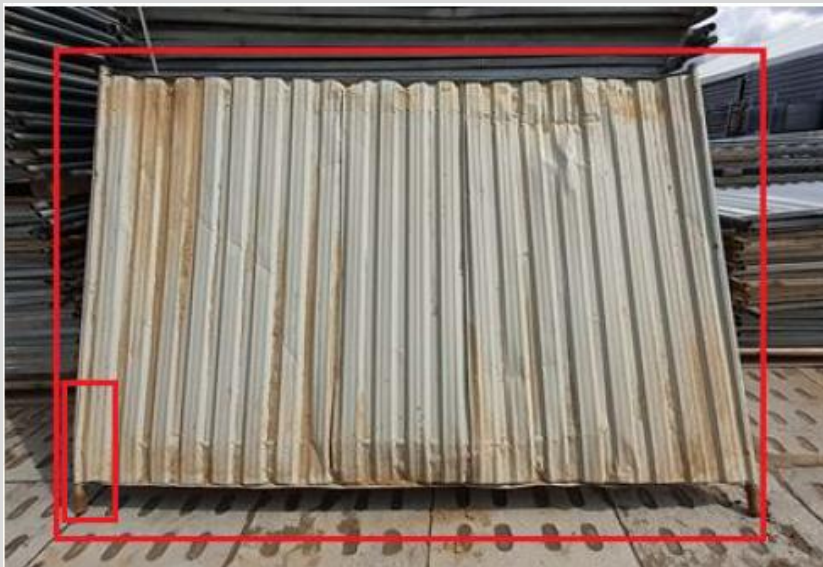
Uszkodzenie niedozwolone – element do KASACJI
