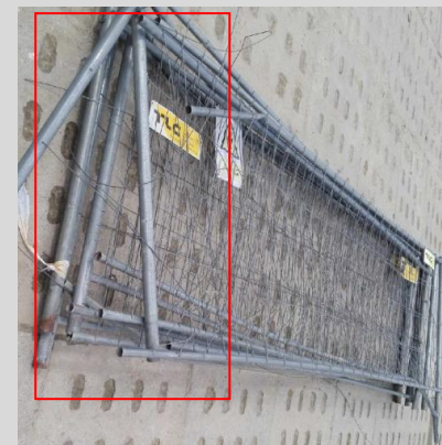
Uszkodzenie niedozwolone – element do KASACJI
