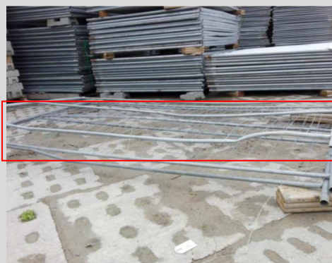
Uszkodzenie niedozwolone – element do KASACJI
