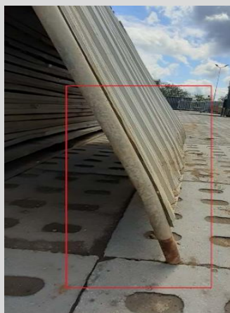
16. Lekkie zagięcia możliwe do wyprostowania
