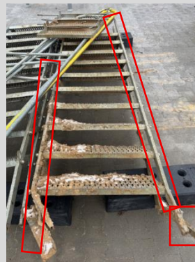
Uszkodzenie niedozwolone - element do KASACJI
