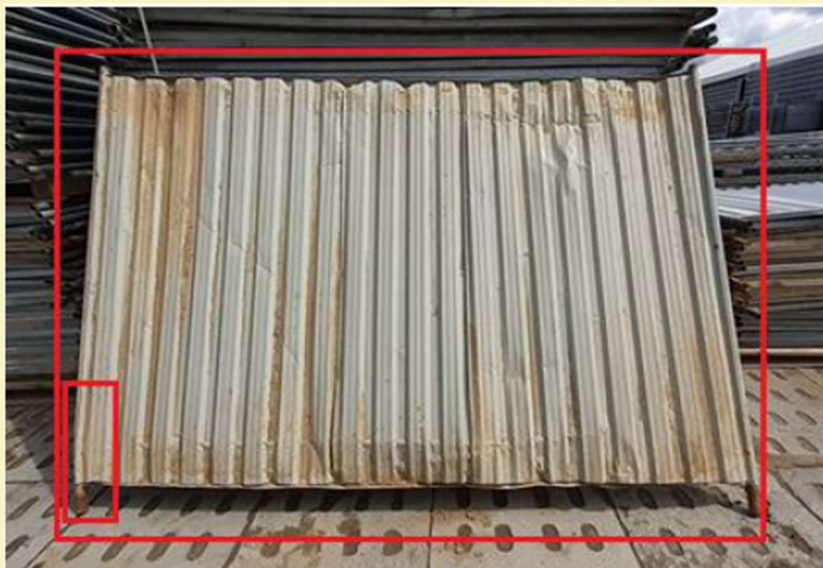
Uszkodzenie niedozwolone – element do KASACJI
