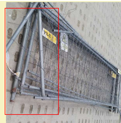
Uszkodzenie niedozwolone – element do KASACJI
