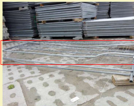
Uszkodzenie niedozwolone – element do KASACJI
