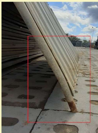
16. Lekkie zagięcia możliwe do wyprostowania
