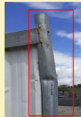
15. Wgniecenie słupka pionowego
