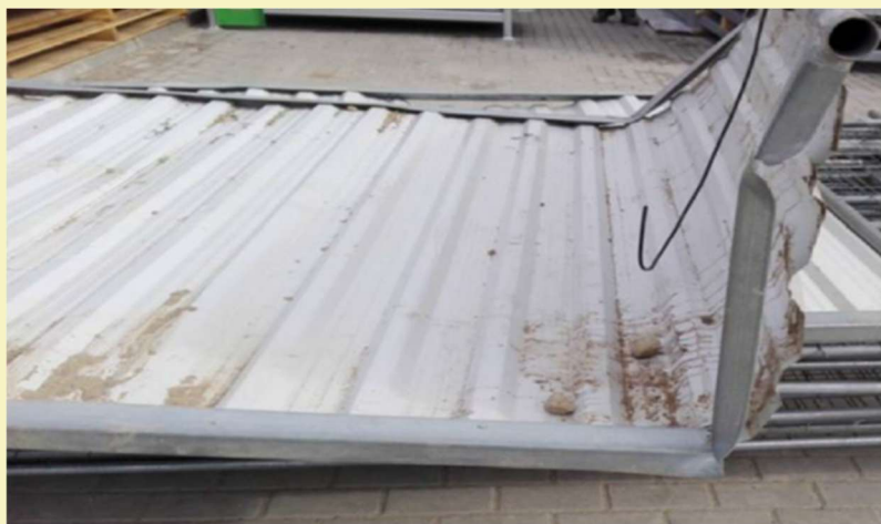
Uszkodzenie niedozwolone – element do KASACJI
